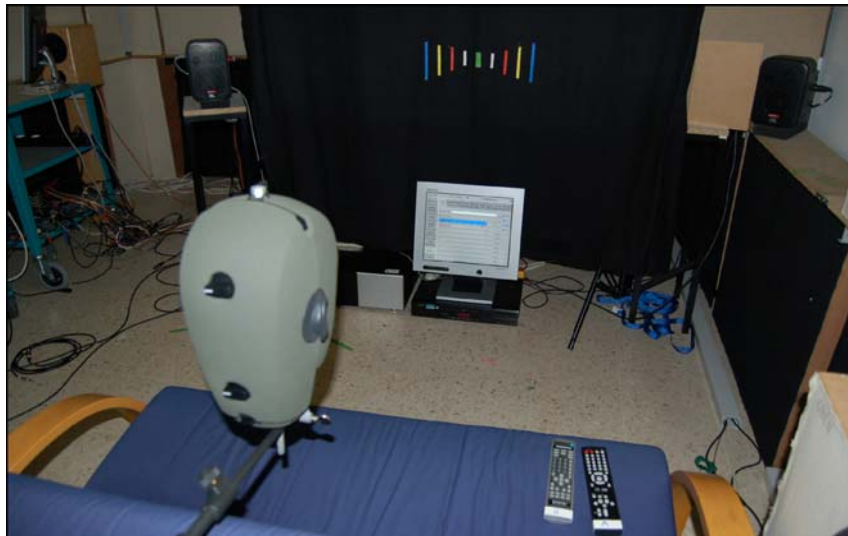
Lautsprecheranordnung für objektive und subjektive Tests
