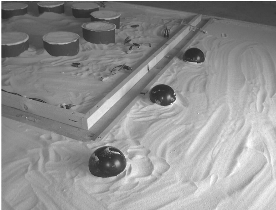
Abb. 4.14: Versuchsaufbau mit Sandaufschüttung für die Körperschalldämpfung
