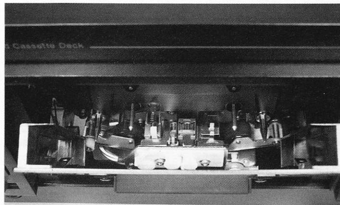
Bild 9 Tonkopffjustage-Getriebe und Bandführungen des CR-7E
