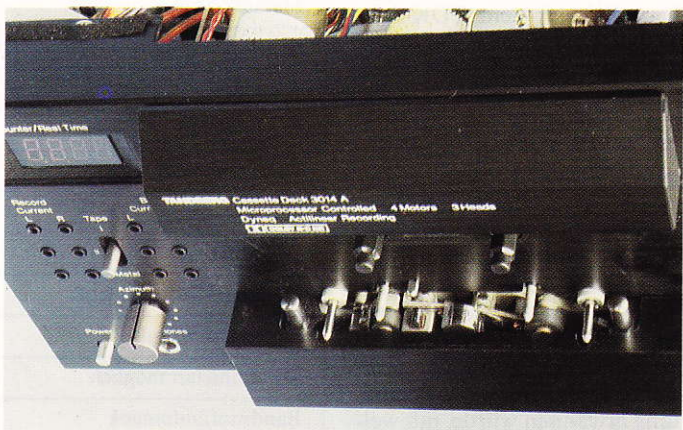
Bild 7 Tonköpfe und Bandführungen des Tandberg mit Azimut-Steller und Einmesssteil
